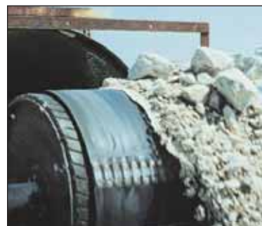
№ 3, самые крупные, предназначены для лент толщиной 15/16 дюйма (24 мм).
